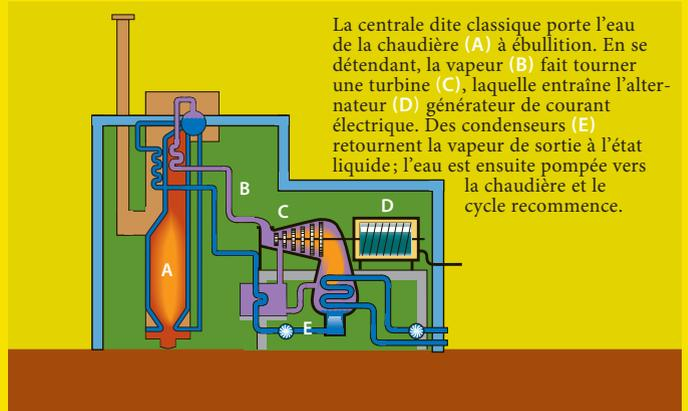
La centrale dite classique porte l'eau de la chaudière (A) à ébullition. En se détendant, la vapeur (B) fait tourner une turbine (C), laquelle entraîne l'alternateur (D) générateur de courant électrique. Des condenseurs (E) retournent la vapeur de sortie à l'état liquide; l'eau est ensuite pompée vers la chaudière et le cycle recommence.
